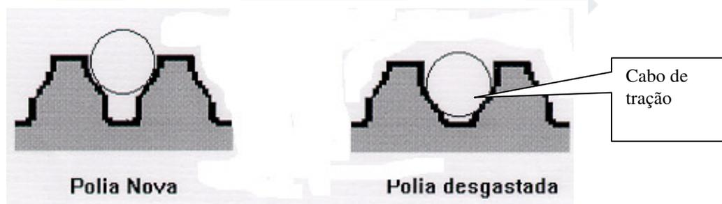
A intensidade de desgaste da polia pode variar conforme a dureza superficial polia, tipo de material, intensidade do uso do elevador, carga da cabina e equalização dos cabos de tração.
